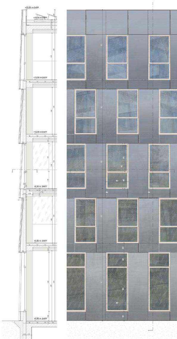
Fassade Schnitt, Ansicht / façade section, elevation
